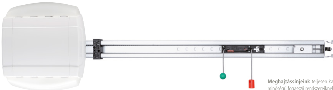
Biztonsági bővítkészlettel Kiegészítő mechanikai biztosítás a kapu illetéktelenek általi nyitása ellen. Ennek során egy retesz bepattan a sínbe és megakadályozza a nyitást.
