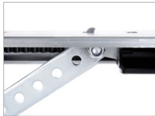
Biztonsági bővítkészlettel Kiegészítő mechanikai biztosítás a kapu illetéktelenek általi nyitása ellen. Ennek során egy retesz bepattan a sínbe és megakadályozza a nyitást.
