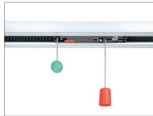
Vészhelyzeti kioldás Áramkimaradás esetén a kapu a vészhelyzeti kioldással nyitható ki és zárható vissza. A kioldás meghúzásával a kapu leválasztásra kerül a meghajtásról, ekkor a kapu manuálisan kezelhető.
